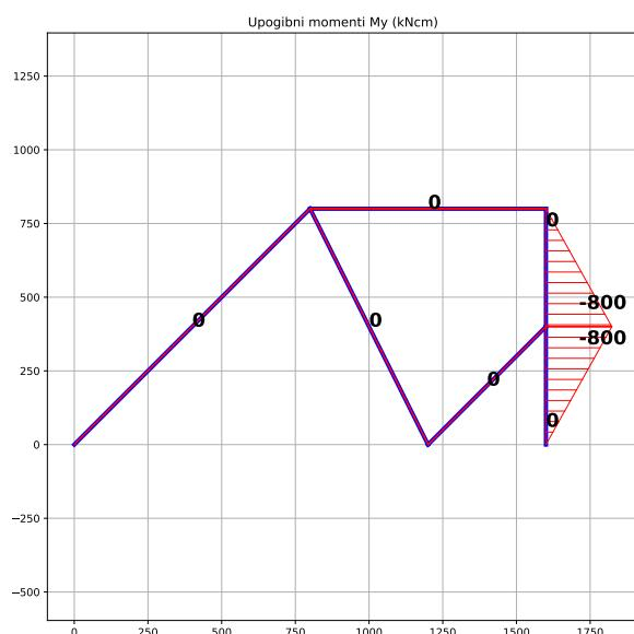
4. Diagrami notranjih sil  $N_x$  (kN),  $N_z$  (kN),  $M_y$  (kNm):
